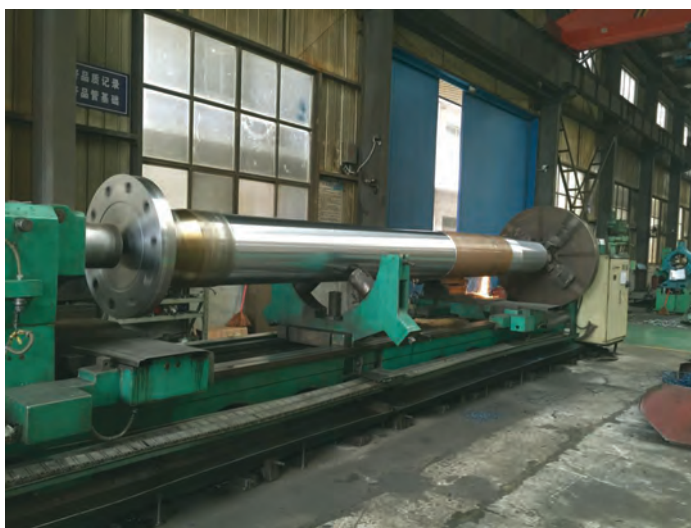
شکل ۹- محور پروانه در کارگاه جهت ماشین‌کاری
