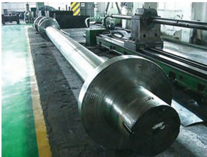
شکل ۱۰- یک نمونه محور پروانه مورد استفاده در شناورهای بزرگ
